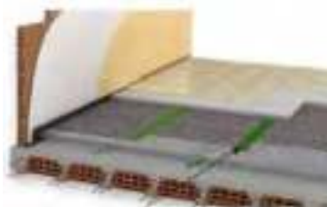
Sección de un forjado donde se indica el material elástico antimpatco
