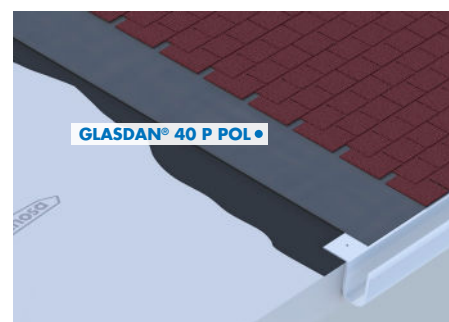
Cubierta inclinada con placa asfáltica
