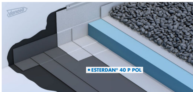
Cubierta plana invertida no transitable
