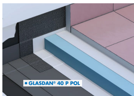
Cubierta plana transitable uso privado
